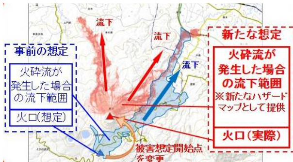
図-4 想定する火口の変化によって氾濫範囲が代わる事例
