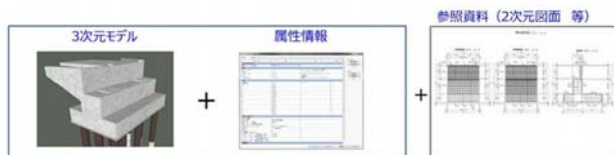
図-1 BIM/CIMモデルの構成
