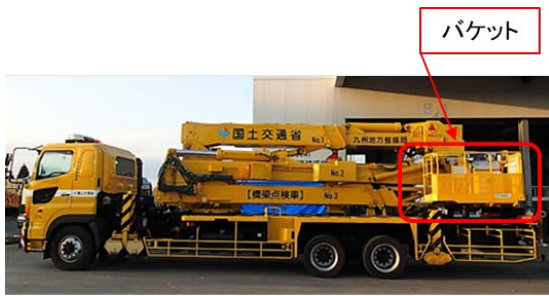
写真-2 橋梁点検車 全景
