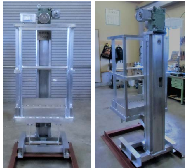
写真-9 橋梁点検昇降装置
