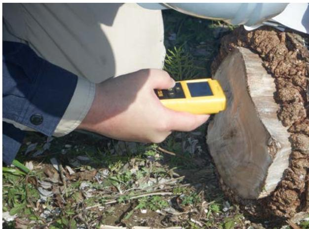
写真 7 木材水分量測定
