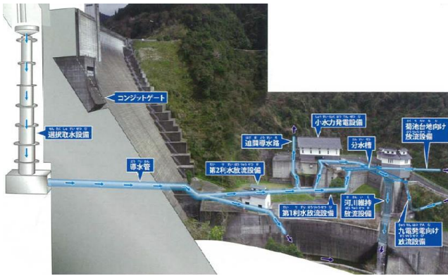
資料－1 (水力発電設備配置)
