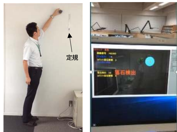
図12 落石判定時間の確認実験状況
