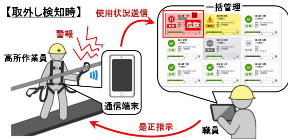
図-17 安全帯使用状況の監視システム
