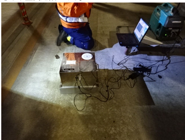
写真-7 CT メーター測定状況
