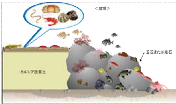
図-4 試験堤のイメージ図
