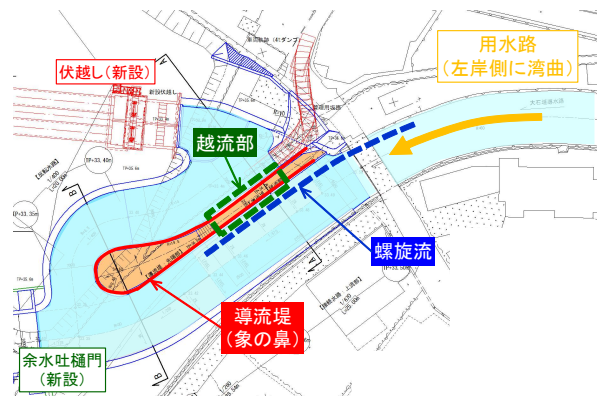
図-9 湾曲部の流れと越流部
