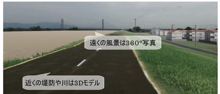
図-10 3Dモデルと風景写真の合成
