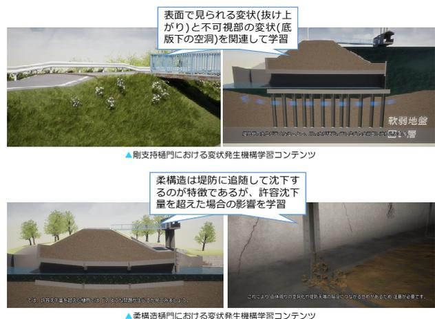
図-8 変状発生機構学習コンテンツ
