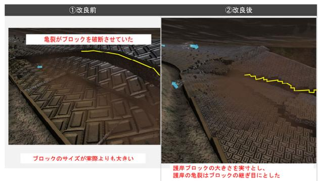
実際のブロックの大きさ(寸法)をブロック化し、護岸の亀裂はブロックの継ぎ目とした。
