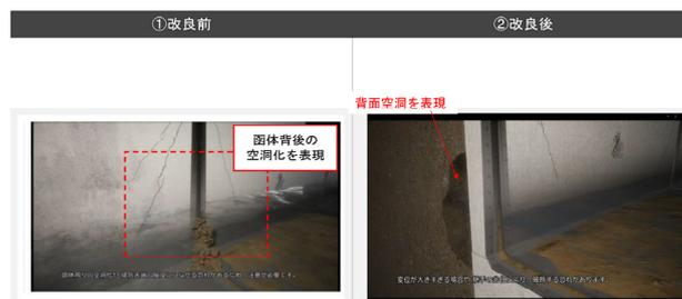
VRの利点を生かして土砂の吸い出しによる函体背後の空洞化の状況を一部透けてみせることで分かりやすくした。
