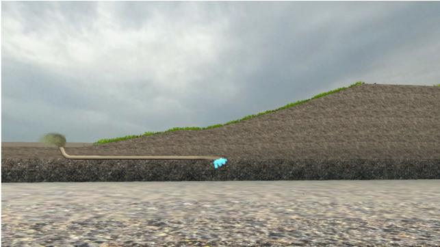
図-11 浸透破堤説明断面図
