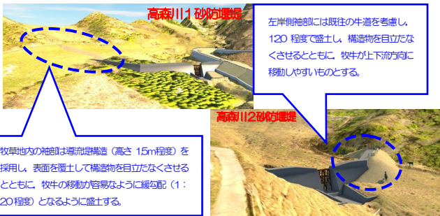
図-15 砂防堰堤完成イメージ（高森川1 高森川2）
