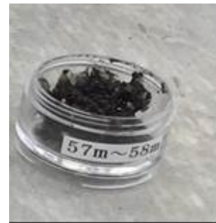
図-21 削孔後別回収スライム
