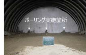
図-8 地質評価のための試験 (上：点載荷試験，下：水平ボーリング)
