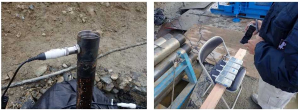
図-14 振動計設置・測定状況
