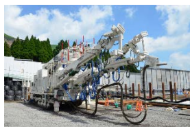
写真-5 コンクリート吹付け機
