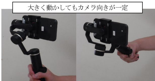
写真-2 ジンバル制御機能付き自撮り棒
