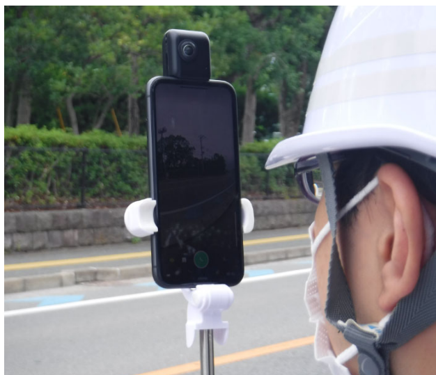
写真-5 360°カメラリアルタイム映像送信状況
