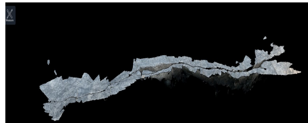
図一4 iPhoneによるクラックの点群測量結果
