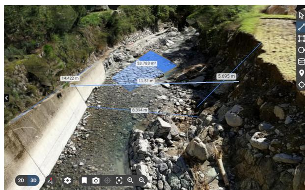
図-2 スマートフォンで作成した被災現場の3次元モデル（令和4年台風14号）
