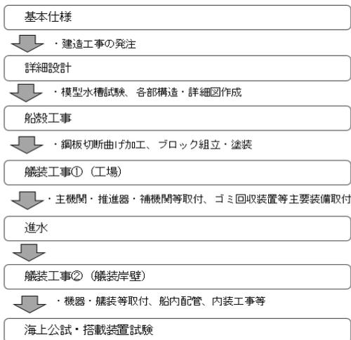
図-2 建造工程フロー図
