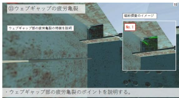
図-22 垂直補剛材の疲労亀裂
