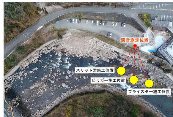
(図 - 11) 騒音振動調査測定位置
