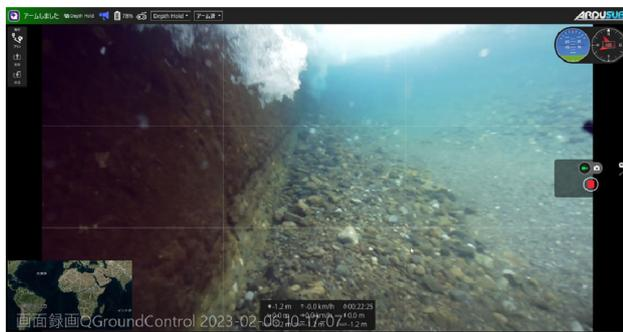
写真-5 水中ドローンによる洗堀調査の状況
