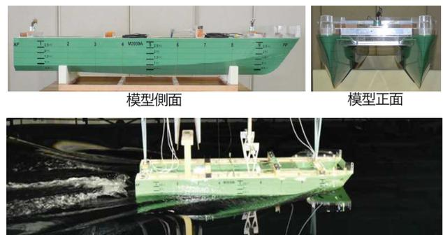
写真-2 模型（上）及び水槽試験状況（下）
