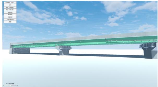
図-4 鋼桁橋3次元モデル(全景)
