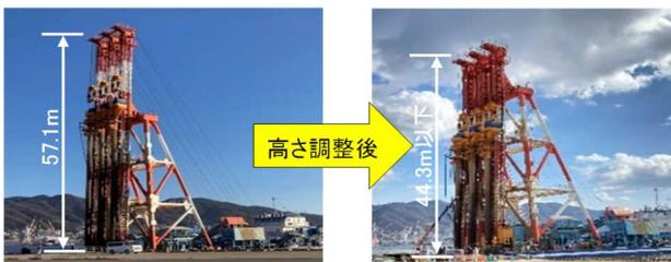
図-9 SCP船の高さ調整前後
