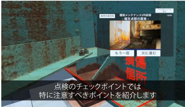
図-8 桁端部の腐食
