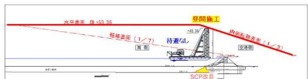
図-12 中仕切護岸における制限表面
