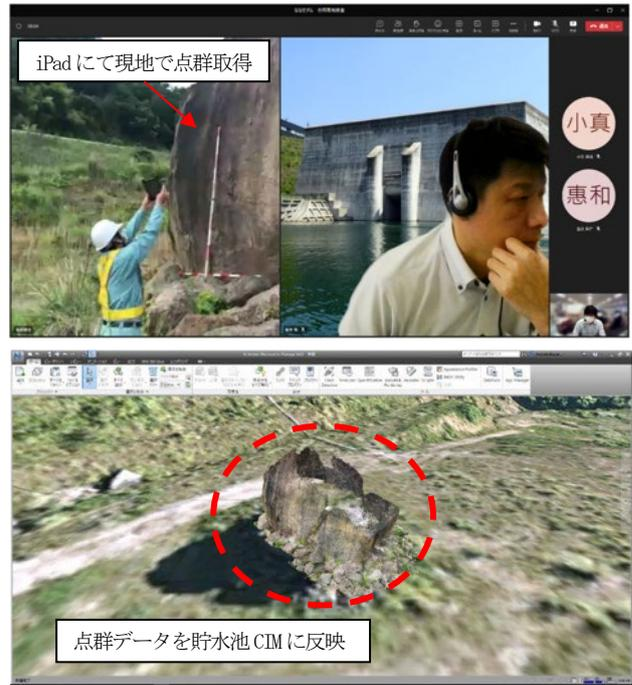
図-15 貯水池CIMを用いたリアルタイム斜面管理
