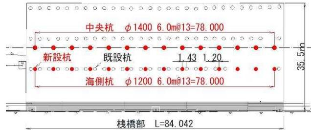
図-3 前畑地区岸壁(10m)改良平面図
