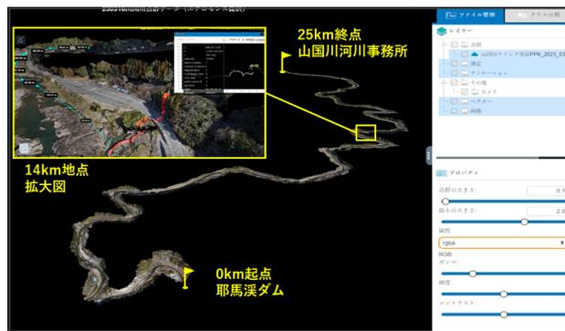
図-5 VTOL機により取得した25km区間の三次元点群データ
