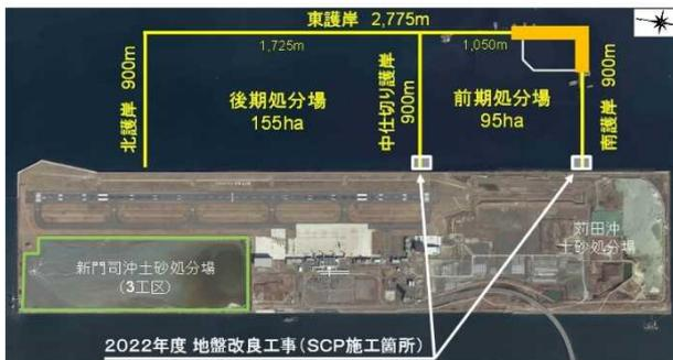
図-8 地盤改良工事（SCP）の施行箇所
