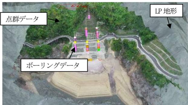
図-7 点群データのCIMでの表示例（UAV撮影写真のSfM解析結果）
