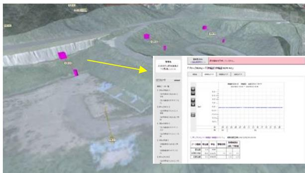
図-10 動態観測結果の表示例 (リンク先の情報は常に更新されているため1時間毎のリアルタイムの情報が閲覧可能)
