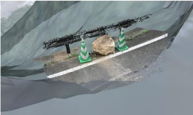
図-14 転石情報の表示例（SfM解析により点群データを生成）
