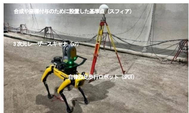
写真-9 自動巡回ロボットと基準点 (スフィア)
