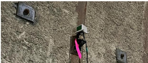
写真-4 インバート掘削前に設置した3D LiDAR
