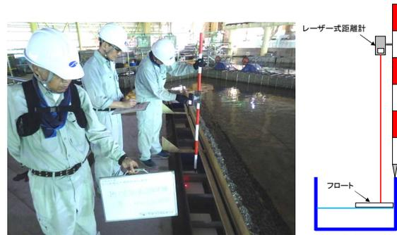
図-8 越波量(集水升水位)の測定
