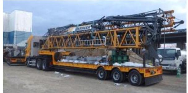
写真-1 ポールトレーラーによる運搬状況
