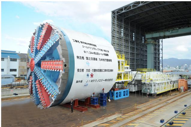
図-4 工場仮組検査完了（合成写真）
