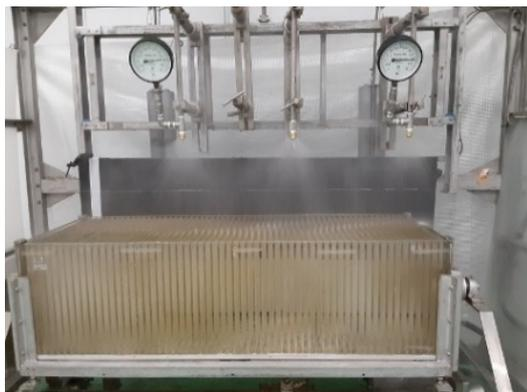
図-5 流量分布試験状況
