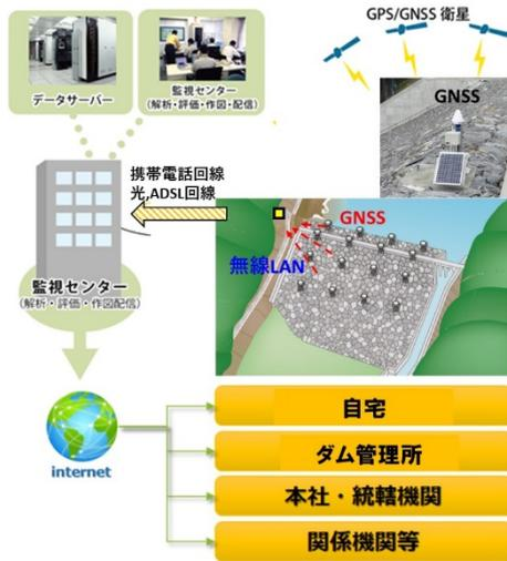
図-5 GNSSによる変位計測システム
