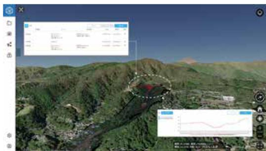
図-9 3Dデータを利用した土量計算の例
