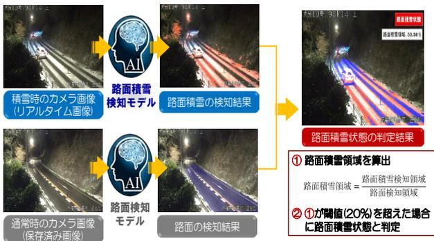
図-3 路面積雪検知モデルの構成図
