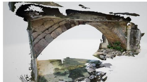
図-10 アプリを用いて三次元データを取得した事例
