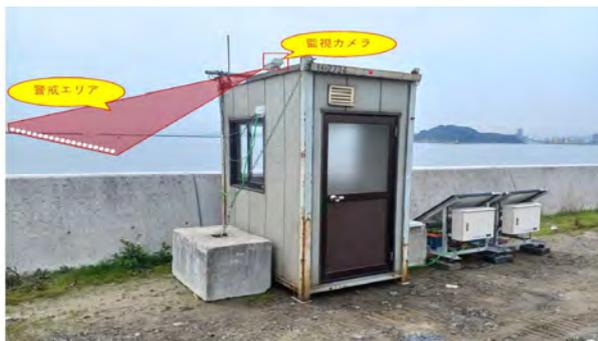
写真-7 「TVセンサー安全監視システム」
