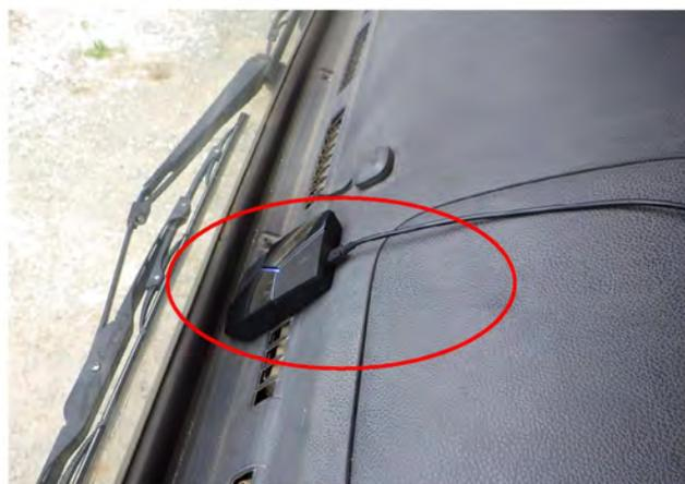
図-5 SC Fleet (工事車両の走行履歴記録機)
