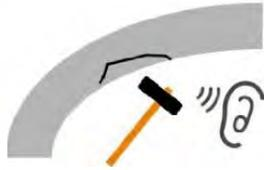
(図2) 通常の打音検査
