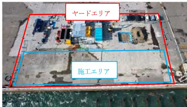
図-9 重機・設備計画図および実際の配置
