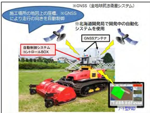
図-10 自動制御システム(九州地整保有の大型機械CG750に設置)
