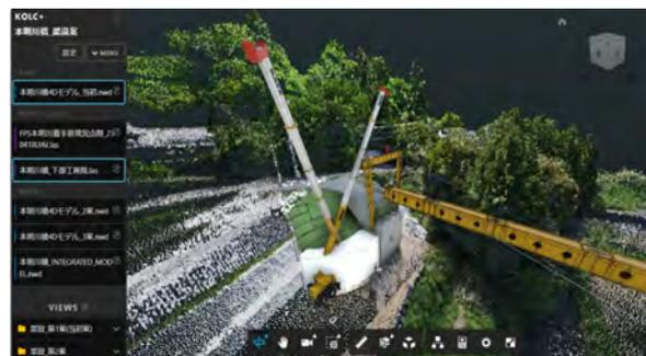
図-6 工事間での施工計画をCIMにて検討
