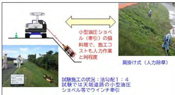
図-4 急勾配対応型除草機械の試行事務所での取組み（山国川河川事務所の事例より）
