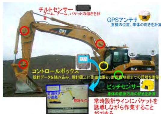
写真8 3次元バックホウ誘導システム
