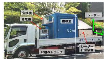
(写真13) レーザー打音検査機器
