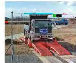
AIカメラによるダンプのリアルタイム入退管理
