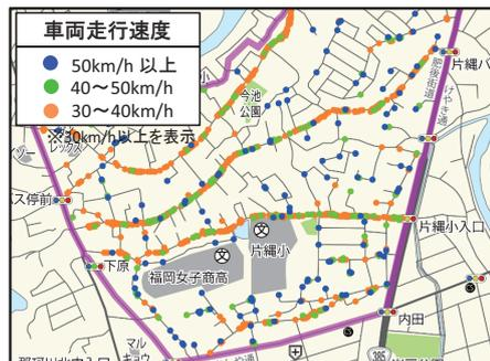
▲ETC2.0プローブ情報を用いた分析(福岡県那珂川市)
