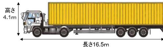
※道路構造の基準を国際海上コンテナ車対応に上げ
