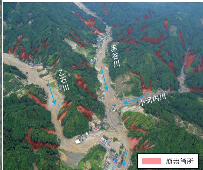
山腹崩壊・被災状況
