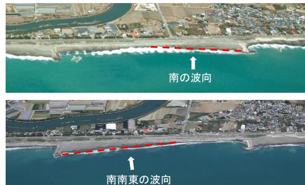
図1 波向きによる海浜地形の変化
