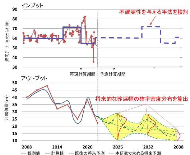
図2 海浜地形の確率的評価(イメージ)
