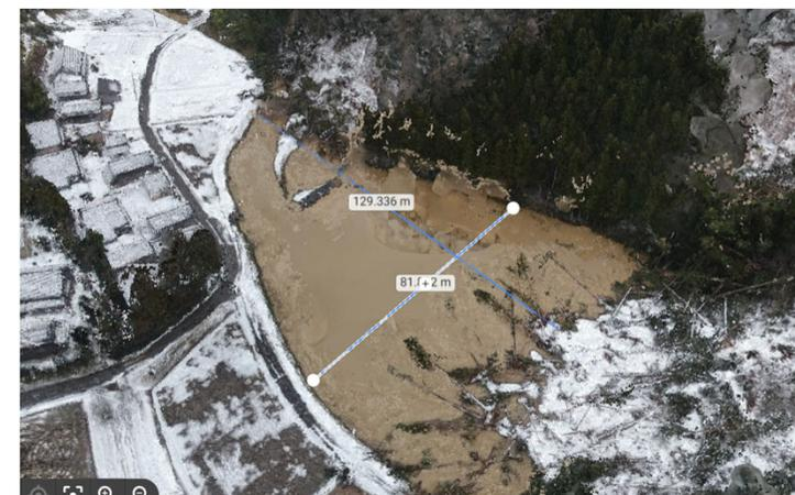
3Dモデルを用いHP上で測量が可能
