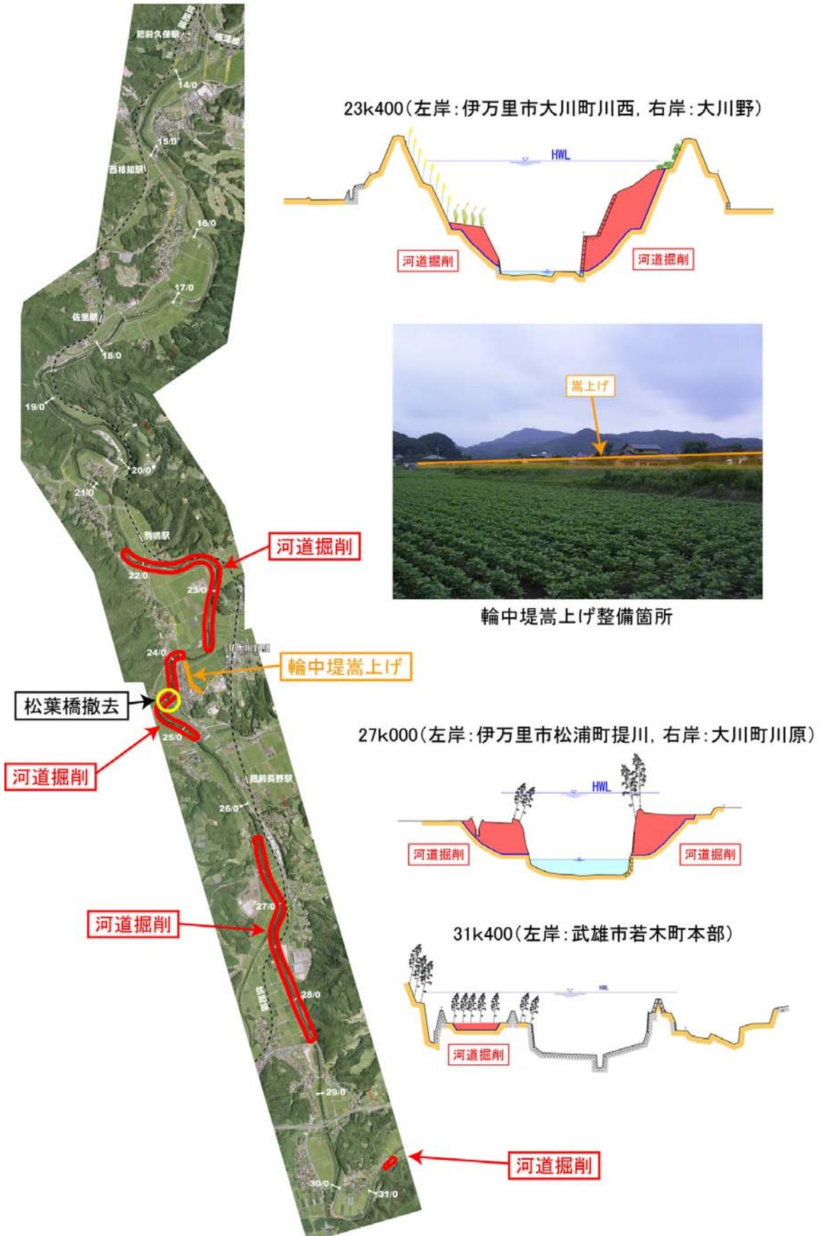
図 4.2.4 整備箇所位置図 (松浦川 14k000~直轄上流端)
