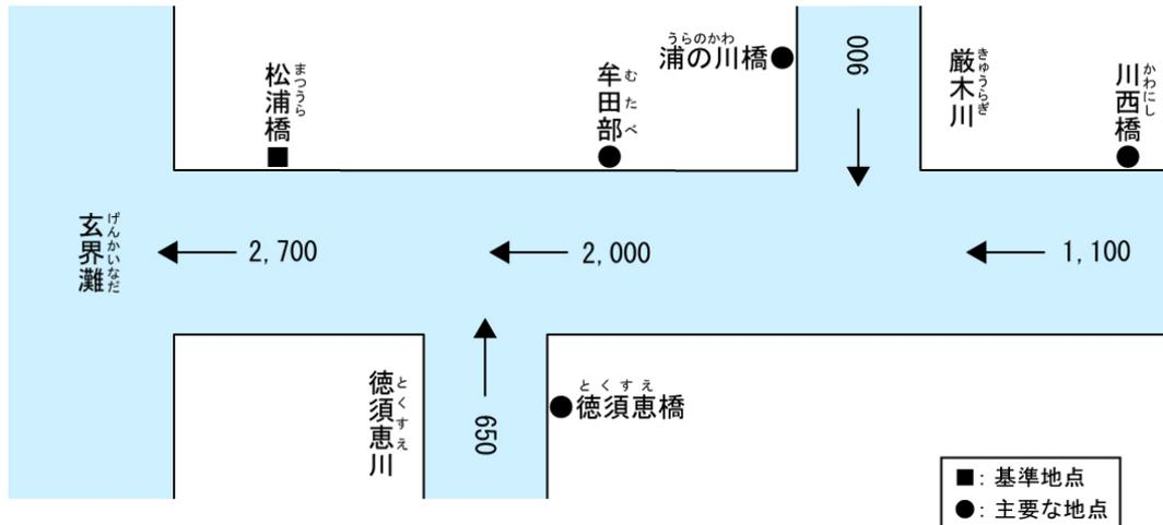
図 4.1.1 河道の整備目標流量図（単位：m<sup>3</sup>/s）
