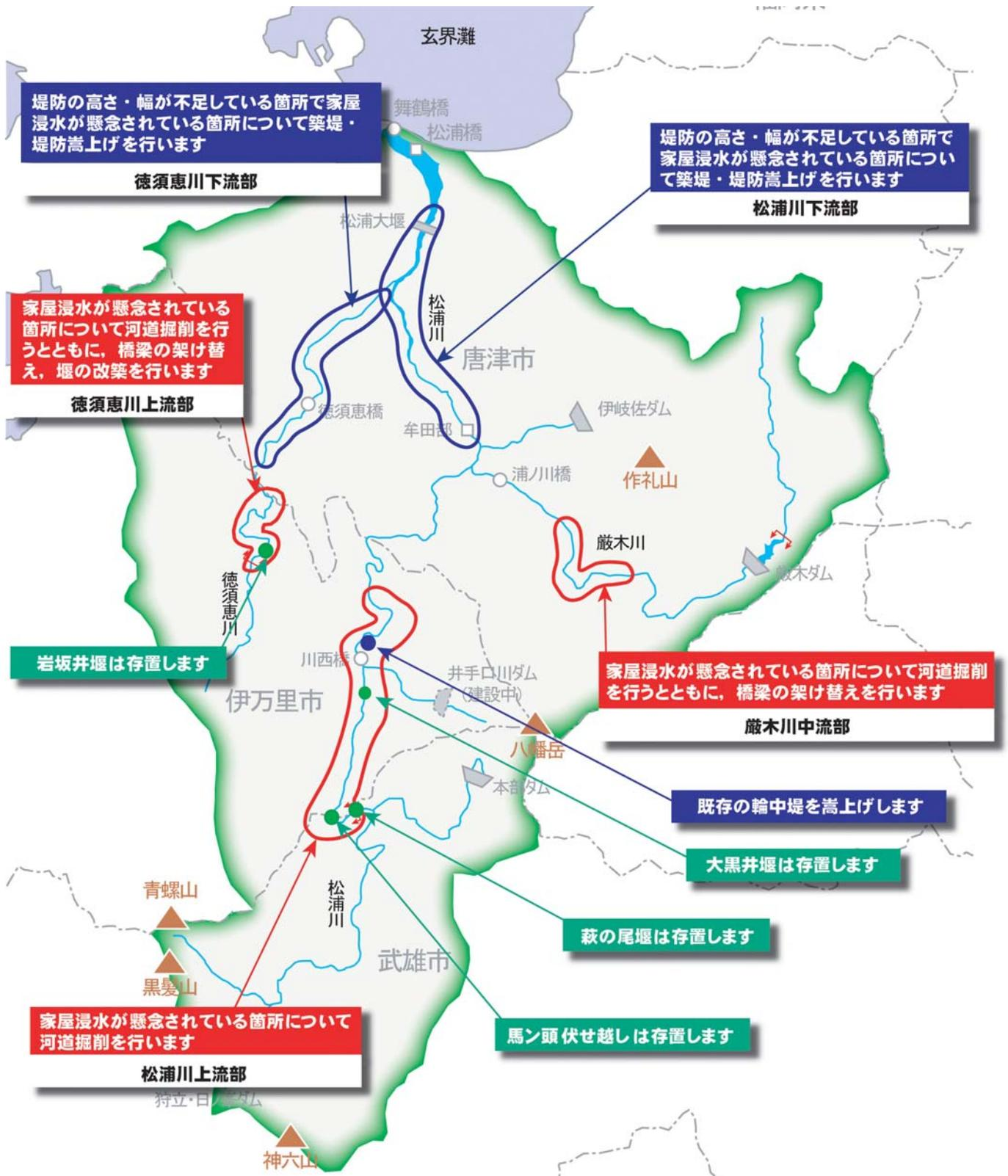
図 4.2.9 洪水による災害の発生防止又は軽減に関する整備位置図
