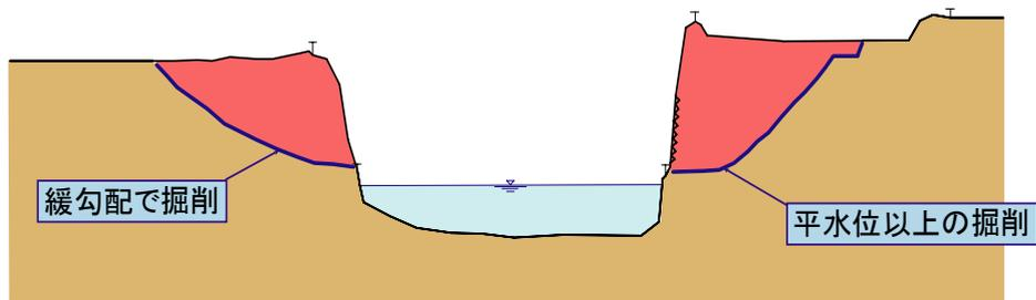
図 4.2.1 河道掘削の概要図
