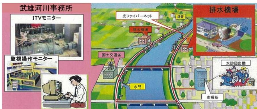
図 4.3.2 遠隔監視操作のイメージ
