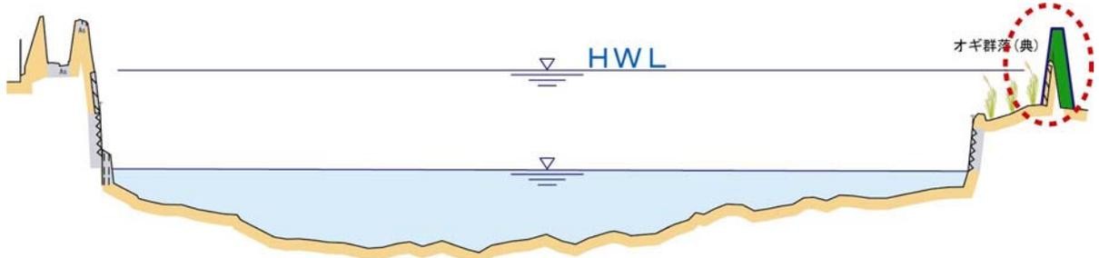
図 4.2.7 堤防整備・嵩上げイメージ図
