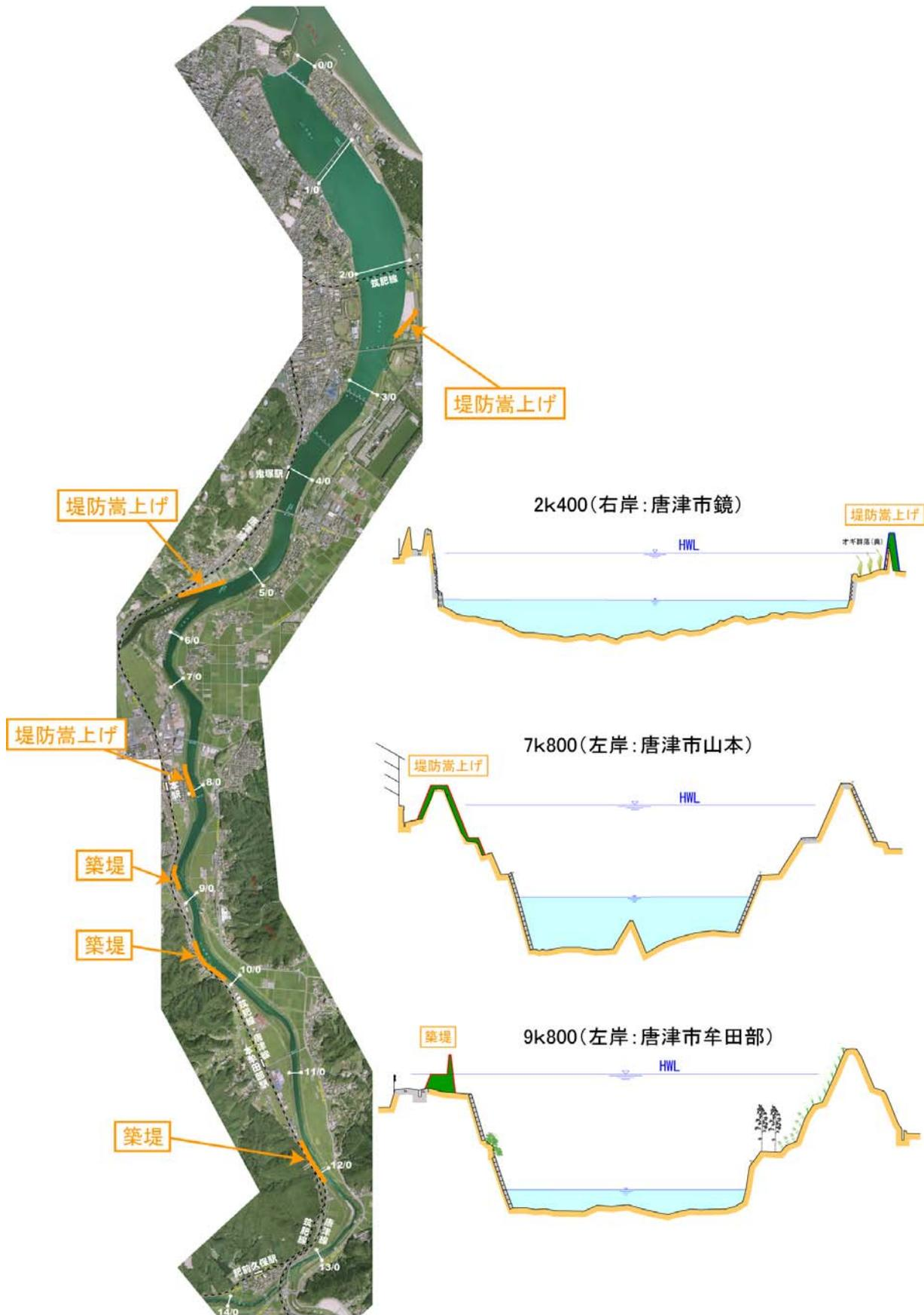
図 4.2.3 整備箇所位置図 (松浦川 河口~14k000)
