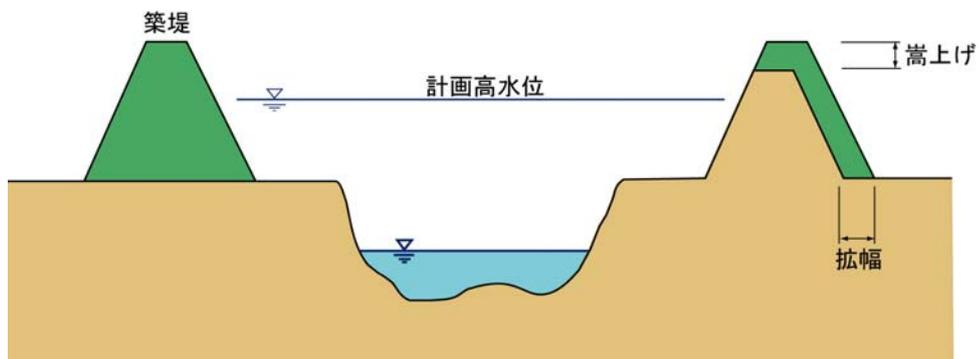
図 4.2.2 築堤、堤防嵩上げの概要図
