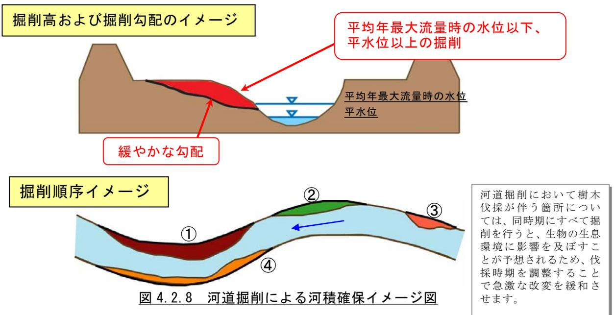
図 4.2.8 河道掘削による河積確保イメージ図
