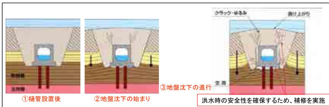
図 2.1.6 地盤沈下の進行
