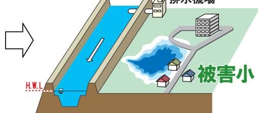
河川の水位上昇を抑制するため、ポンプを一時的に停止し、内水排水を規制します
