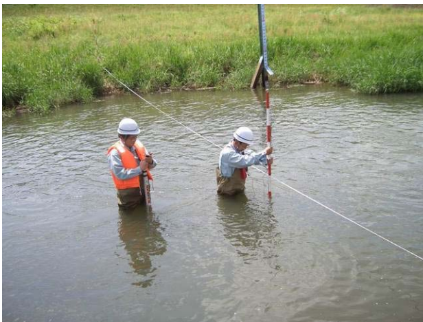
写真 5.2.3 河川の流量観測（低水流量）
