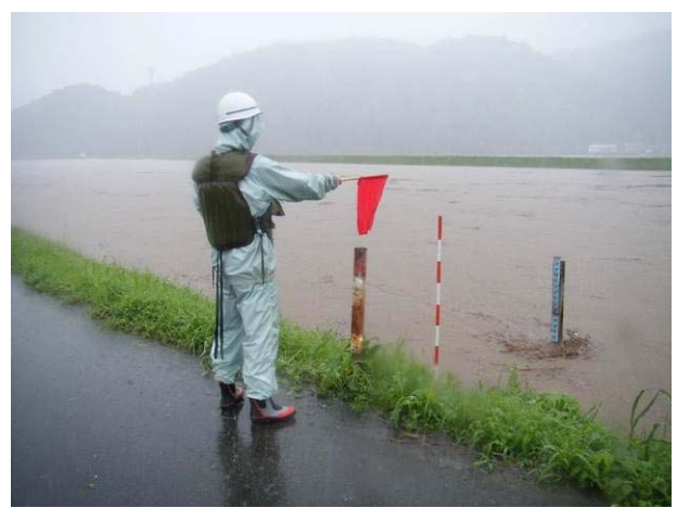
写真 5.2.4 河川の流量観測（高水流量）
