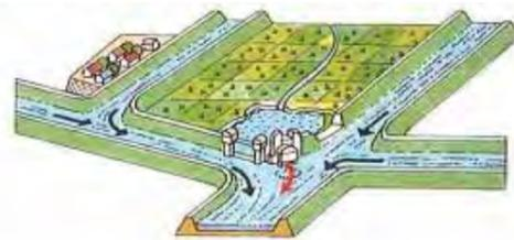
牛津川が大きな洪水となったときには、洪水の一部を越流堤から計画的に遊水地内に導き、一時的に貯留し、牛津川下流域の洪水被害を減らします。
