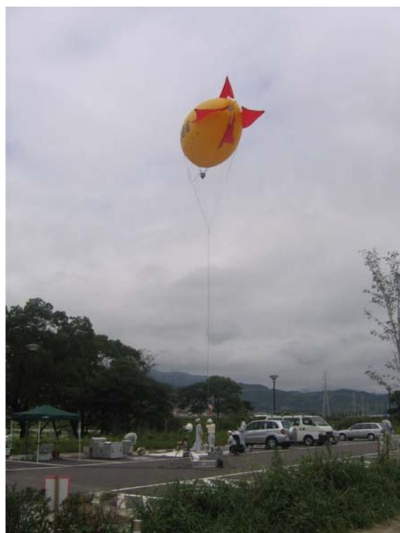
写真 2.1.15 気球空撮装置
