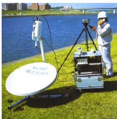
写真 2.1.14 衛星小型画像伝送装置
