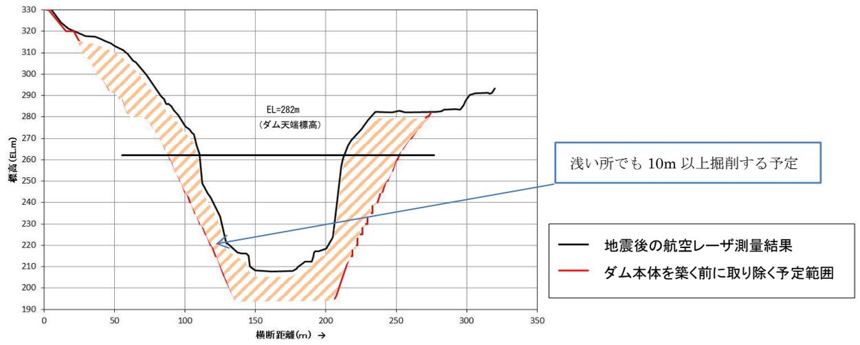
図-1 基礎掘削断面図
