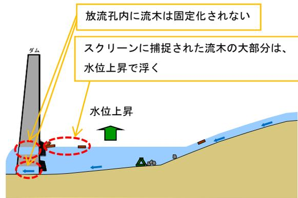
水位が上昇すると流木も浮きますが放流する穴にはスクリーンを設置しており、流木はスクリーンに捕捉されます。
