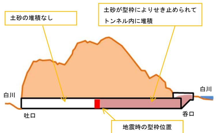
図-1 仮排水路トンネルの縦断イメージ
