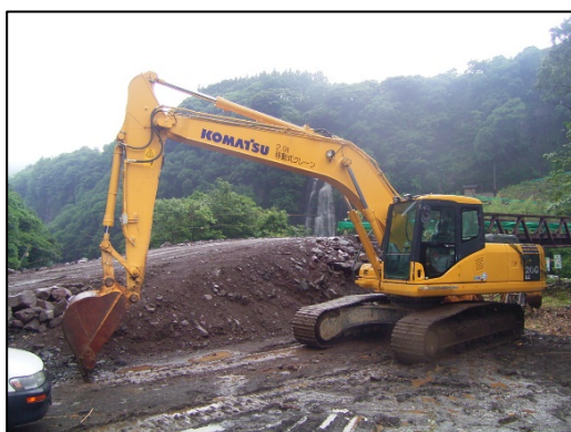
写真 6.2-1(2) 使用している低騒音型建設機械
