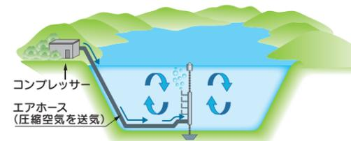
曝気循環装置イメージ図
