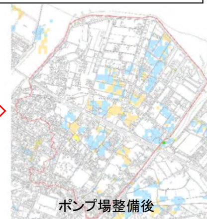
浸水シミュレーションによる効果検証（1/50年降雨）
