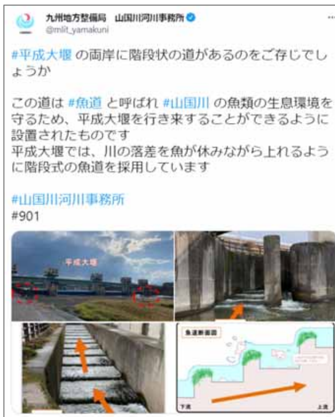
山国川河川事務所SNSによる平成大堰魚道の機能の紹介
