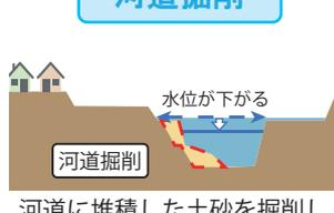
河道に堆積した土砂を掘削し、流下能力を上げます。
