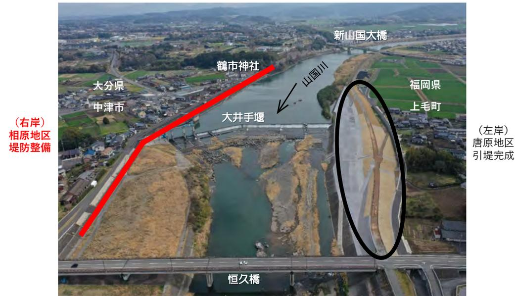
○相原地区については、約0.5mの嵩上、約1.0mを拡幅する堤防整備及びその付帯施設の整備を実施中。
