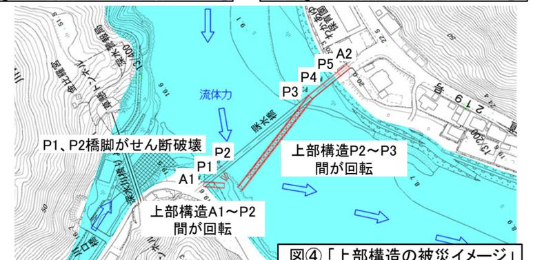
図④「上部構造の被災イメージ」
