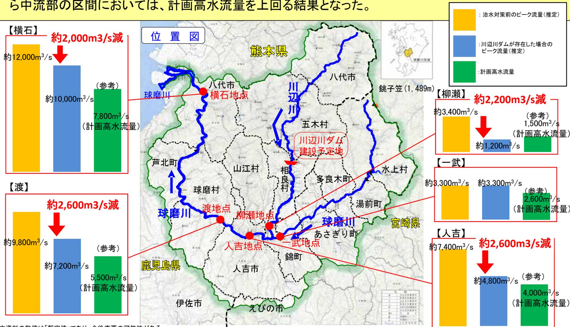
○仮に川辺川ダム(貯留型)が存在した場合を想定し、従来から検討してきた貯留型ダムでの洪水調節ルール(河川整備基本方針検討時のルール)を用いて、川辺川ダム洪水調節後の主要地点の流量の時間的な変化を推定すると、以下のとおりとなる。
