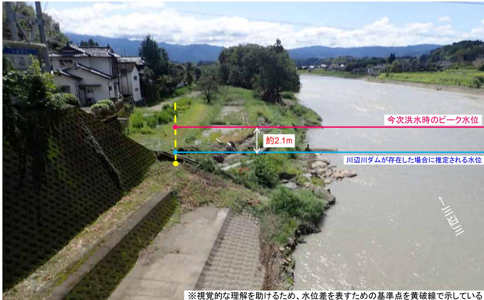
○仮に川辺川ダムが存在した場合を想定し、「相良村永江地区(川辺川7k200付近)」の川辺川ダム洪水調節後のピーク水位を算定すると、河道の水位が今次洪水に比べ約2m程度低下すると推定される。
