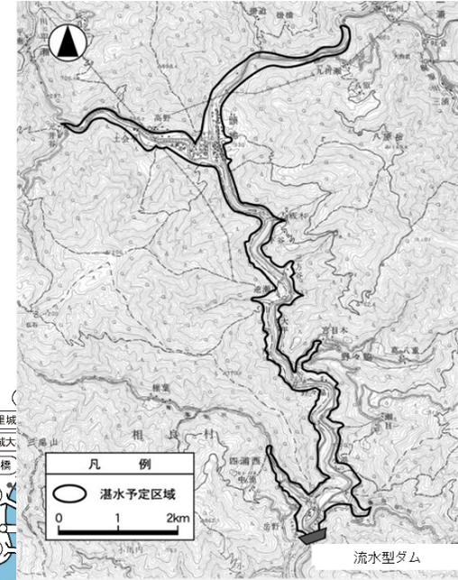
図 流水型ダムの貯水地平面図
