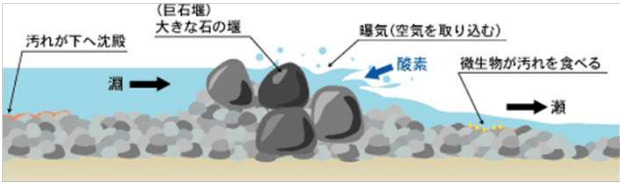
河川の自然浄化作用の概要図
