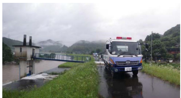
図 2.22 排水ポンプ車（活動状況）
