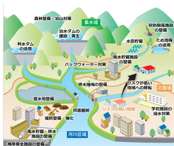
図 6.8 流域治水の施策イメージ図
