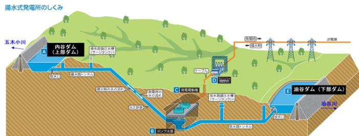
油谷ダム・内谷ダム揚水式発電のしくみ
